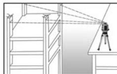
Repère pour l'installation d'un plancher de ciment
